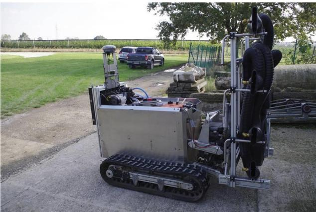
Foto 2. Il veicolo elettrico 'rover' sviluppato nel progetto. Notare il piccolo motore a scoppio che aziona l'atomizzatore. La maggior parte del corpo della macchina è costituita da un serbatoio di 250 litri per i trattamenti.
